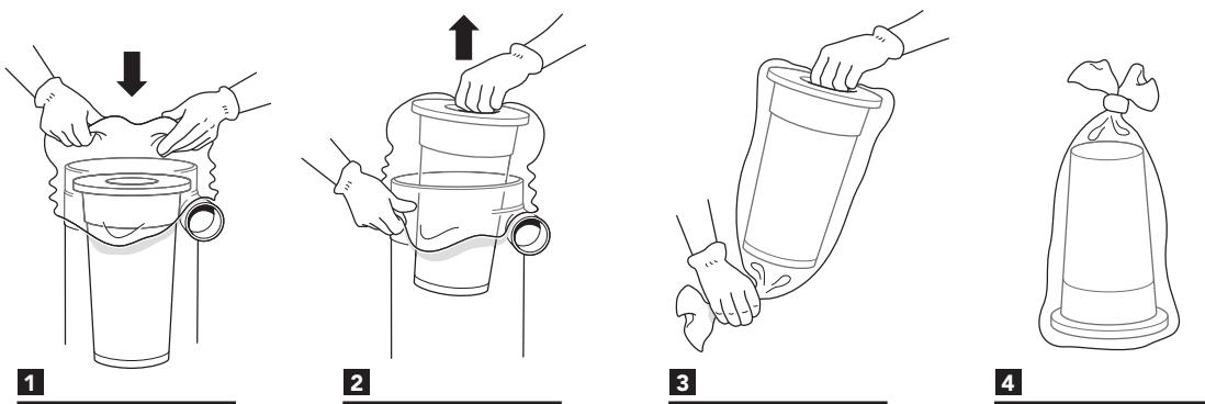
HEPA-filteret fjernes ved at man åpner lokket og løsner patronen. Ved å forsiktig vippe det løse motorhodet bort fra syklonen oppstår det et sidetrykk på HEPA-filterpatronen, som er festet til motoren. Ved behov kan du gjenta prosedyren til HEPA-filteret faller inn i finfilterpatronen. Deretter kan HEPA-filteret og finfilteret kasseres. Den nye filterpatronen sitter i finfilteret, og den forsegles når du setter lokket forsiktig på plass.
