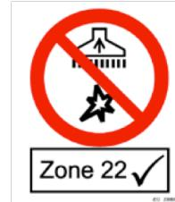
Dieser Standard beinhaltet die Sicherheit von Staubsaugern mit Elektromotoren, einschließlich Staubabscheider und Rückenstaubsauger, zum Nass-, Trocken-, oder Nass- und Trockensaufen, vorgesehen für den gewerblichen Einsatz im Innen- und Außenbereich mit und ohne Zubehör, um brennbaren Staub in einer als explosiv ausgewiesenen Atmosphäre (Zone 22) aufzunehmen.
