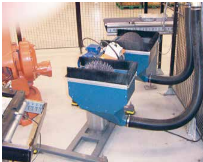
Robotavgrädning för telekomdelar
