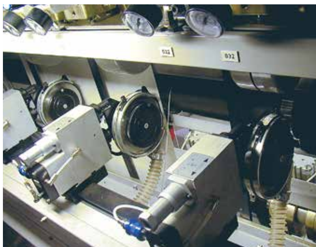
Sugkåpa monterad på skärkniv i tryckpressen
