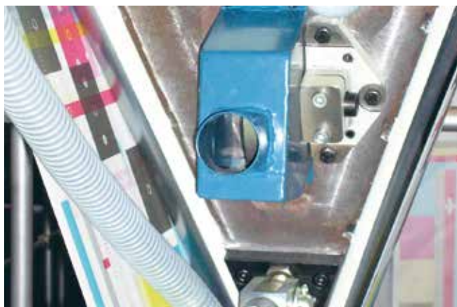
Sugkåpa monterad på skärkniv i tryckpressen
